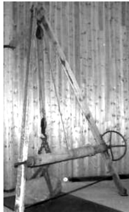
En steinbukke, også kjent som stubbebryter.
