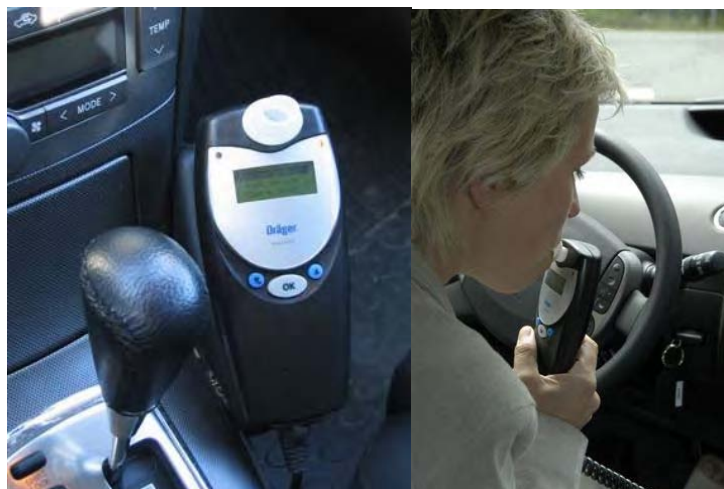
Bilde 1 Alkolås, en teknisk inntretning for å hindre kjøring med promille
